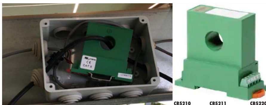
תמונה 10 חיישן זרם CR5200 הפועל על ידי אפקט הול
