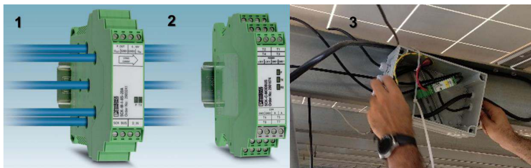
איור 17 מכשיר מדידת מתח (1) רכיב SCK-M-I-8S-20A אשר מודד נתונים (2) רכיב SCK-C-MODBUS אשר אוסף ושולח נתונים מדודים (3) תצלום של רכיב SCK-M-I-8S-20A מותקן בשטח הניסוי
